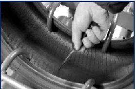
Remova o objeto que danificou o pneu e limpe a área afetada tomando cuidado para não aumentar o dano e não afetar a estrutura do pneu.
