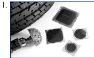
O reparo foi desenvolvido para a reparação de danos em pneus radiais e diagonais de automóveis e camionetas, na região da banda de rodagem e flancos. Em pneus de automóveis não são permitidas reparações na área dos flancos.
