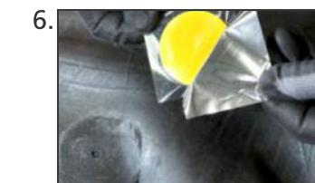
Remover o filme de proteção da base e aplicar o Remendo centralizando-o sobre o dano.
