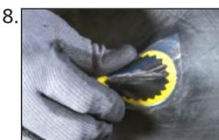
Remover o filme de proteção da superfície do Remendo, do centro para as bordas, rompendo o pontilhado.
