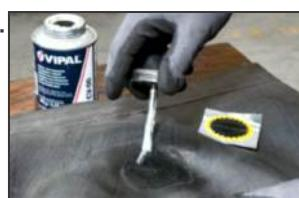
Com a utilização de um pincel, aplicar uma camada uniforme de Cemento Vulcanizante CV em movimentos circulares.
