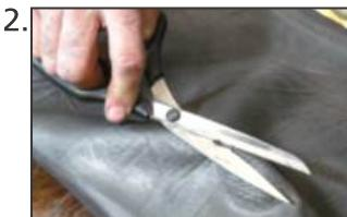
Para danos no formato de rasgo, arredondar as extremidades utilizando uma tesoura.
